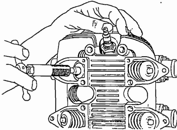
Fig. B18. Valve grinding
